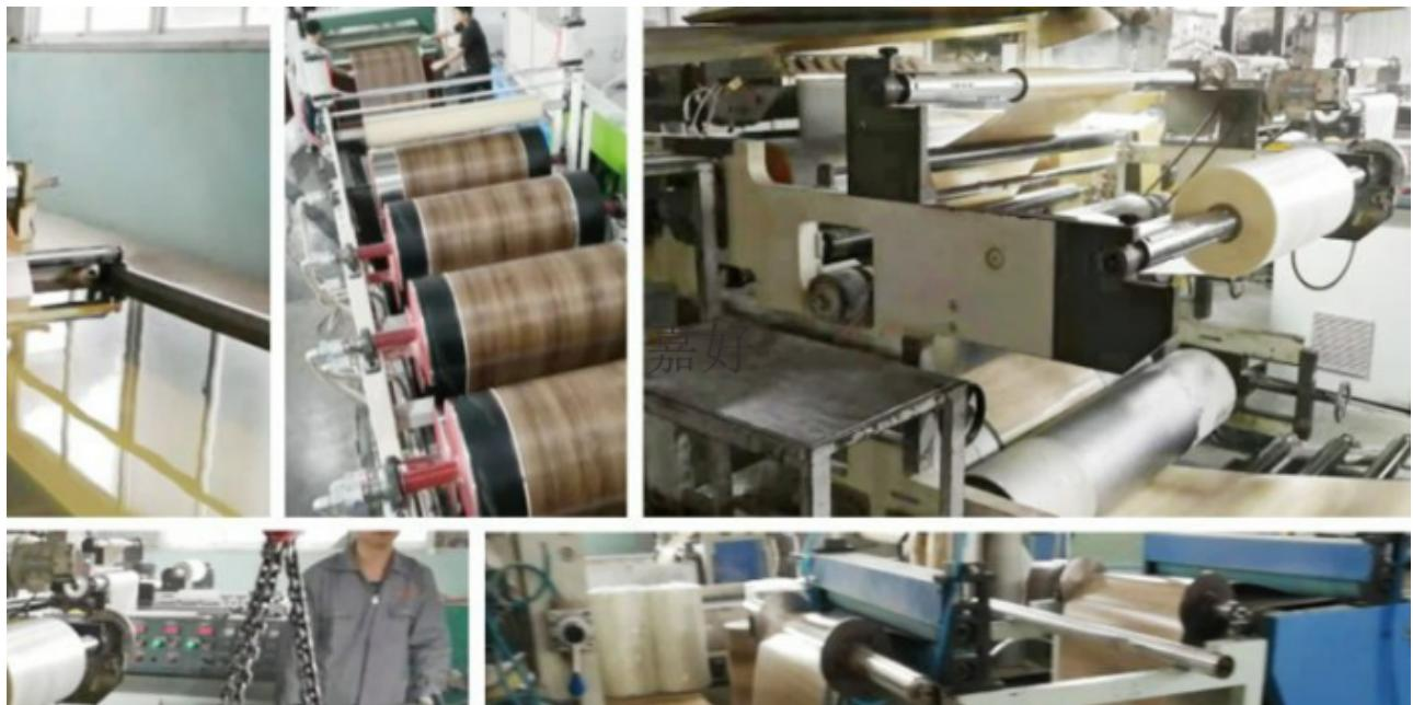
三、SPC地板①②③SPC地板的结构：目前市场上的SPC地板包括三类，在线贴合的单层SPC地板④LVT与SPC复合的AB结构和ABA结构的SPC复合地板⑤⑥SPC地板的主要成分：同样是PVC类的地板产品，其主要原材料的种类基本一致的，与LVT地板不同的是⑦SPC地板基材在生产过程中加入了润滑剂，以便更顺畅的完成挤塑⑧⑨SPC地板生产工艺：与WPC地板基材类似⑩SPC基材也是由挤塑机挤塑压延成片状板材，再在表面贴合彩膜和耐磨层。若为AB或ABA结构的SPC复合地板，则先挤塑出SPC基材，在通过组坯复合的方式压贴LVT层。以上就是LVT地板⑪WPC地板⑫SPC地板的区别，这三种新型地板，其实也算是PVC地板的衍生品。这三种新型地板由于材料特殊，与木地板相比应用更\*\*\*，在欧美市场\*\*\*流行，国内市场还有待普及。
